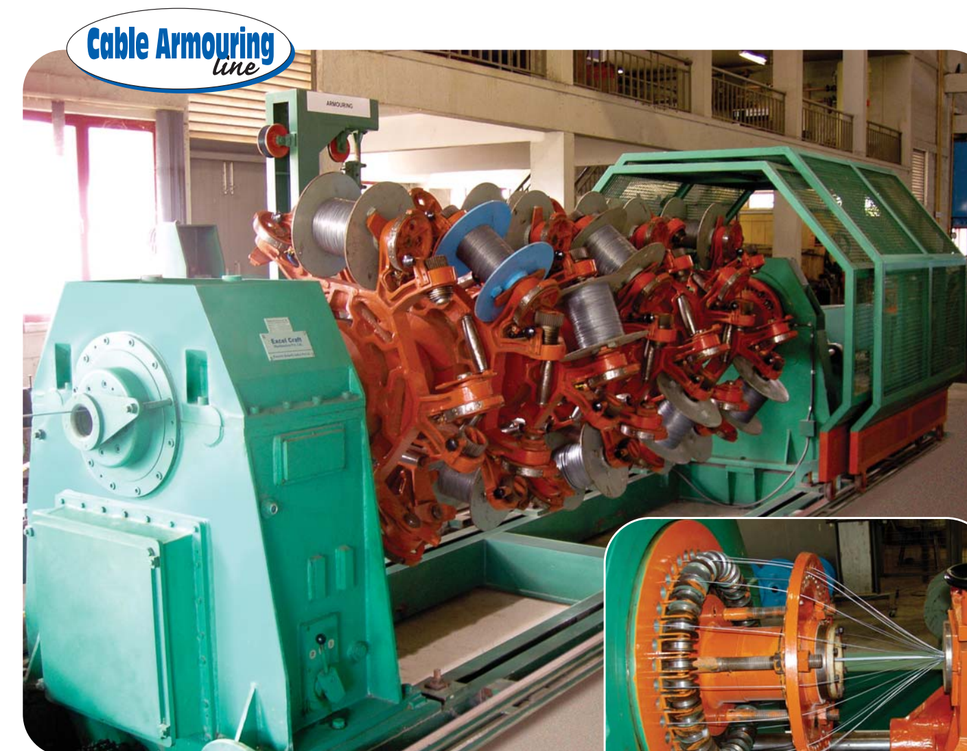
No of Bobbins : 42 ~ 84 Bobbin Dia : 400/ 500 Machine RPM : 150
